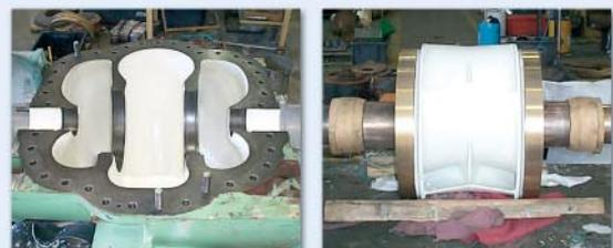
Réparer l'arbre usé et corrodé en utilisant avec Loctite® 3478 Superior Metal. Après polymérisation complétée d'un usinage, revêtir toutes les pièces avec Loctite® Nordbak® 7228 Finition anti-usure blanc.
