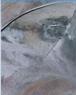
Roue et corps de pompe avant réparation. Usures sévères dues à la cavitation sur la roue
