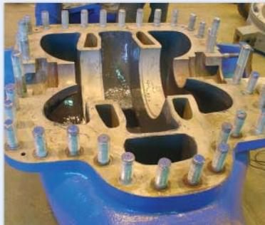
Photo 4 : Surface complètement revêtue puis, après polymérisation partielle, application de la seconde couche
