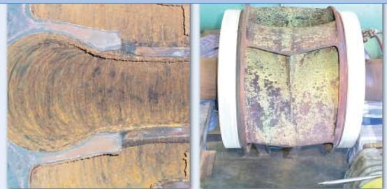
Roue de pompe en bronze et corps de pompe avant réparation. Première étape : abrasion des pièces selon SA-3 décapage à blanc (profil de surface : 75 µm).
