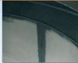
Application du Loctite® 7227 sur lignes de soudure
