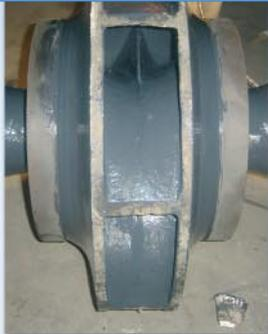
Les piqûres dans la roue ont nécessité l'utilisation de Loctite® Superior Metal 3478. Loctite® Nordbak® 7227 Finition anti-usure a été appliqué en deuxième couche.
