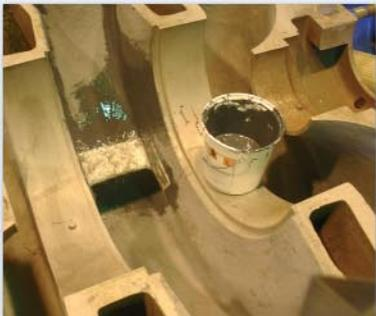
Photo 3 : Application du Loctite® 7227 sur corps de pompe et coupe flux
