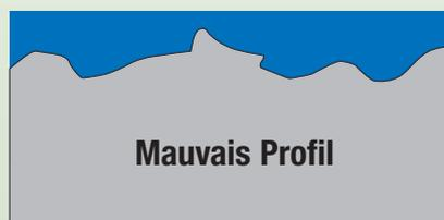
*Le profil de surface est inadapté de part le faible ancrage créé. Il engendre donc une mauvaise adhérence du produit.*
