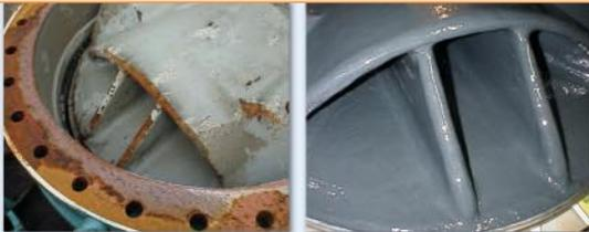
La vanne papillon corrodée – avant et après réparation
