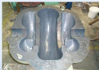
Loctite® Nordbak® 7227 Finition anti-usure gris appliqué pour étancher le corps de pompe. Recharger les zones corrodées et usées avec le mastic anti-usure Loctite® 7222.
