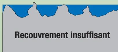
*Manque d'épaisseur de revêtement. Les pics de surface peuvent, par manque d'épaisseur de revêtement, être exposés à la corrosion et/ou à la contamination.*
