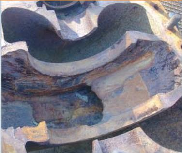
Photo 1 : Corrosion et érosion sont mis en évidence
