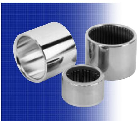
Les roulements à aiguilles massifs sont constitués d'une bague extérieure rectifiée et rainurée et d'un jeu d'aiguilles retenues et guidées par une cage. L'épaisseur de la bague extérieure massive apporte une capacité de charge et une résistance aux chocs maximales tout en restant contenu dans une section relativement réduite.
