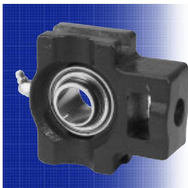
Les paliers tendeurs sont utilisés lorsque l'application requiert un dispositif de réglage d'arbre ou de tension de courroie. Les paliers tendeurs sont disponibles avec des roulements à billes ou à rouleaux. Le corps des paliers est fabriqué en fonte ou en acier moulé selon les modèles. La longueur de course est ajustable entre 457,2 mm (18") pour les roulements à billes jusqu'à 915 mm (36,0236") pour les roulements à rouleaux.
