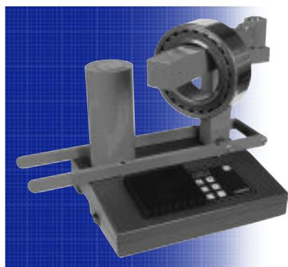
Un montage approprié prolonge la durée de vie des roulements. Pour le montage de roulements ou d'autres composants mécaniques, le chauffage par induction est plus performant que les méthodes traditionnelles. En plus d'assurer une chauffe régulière et non destructive, il permet une installation plus rapide donc plus économique. Aucune préchauffe n'est nécessaire et le chauffage par induction est rapide, sûr et respectueux de l'environnement.
