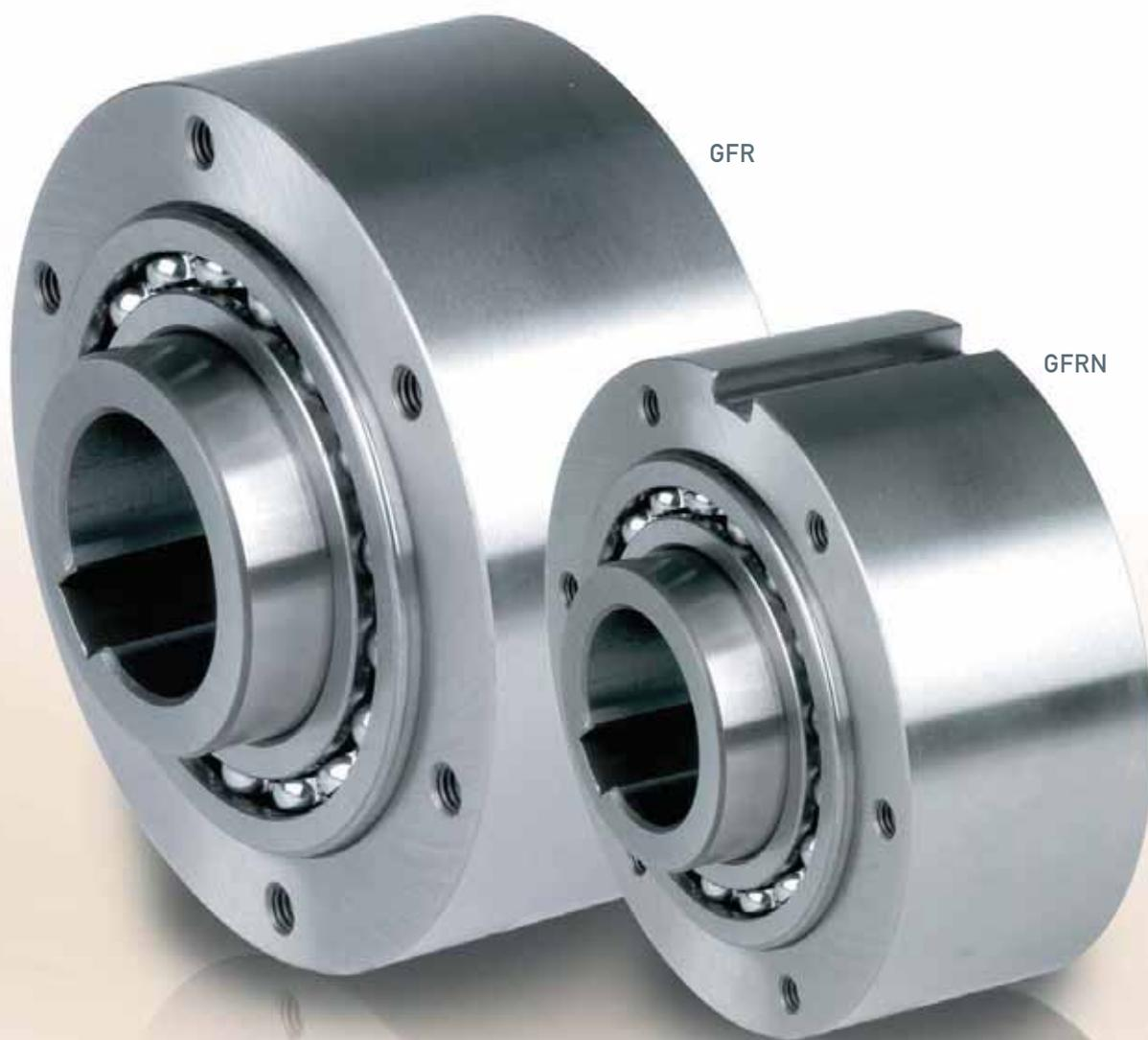
Les modèles GFR, GFRN sont des roues libres à rouleaux. Ce sont des modules de base autocentrés par deux roulements série 160.. En standard, une lubrification à l'huile est à prévoir.
