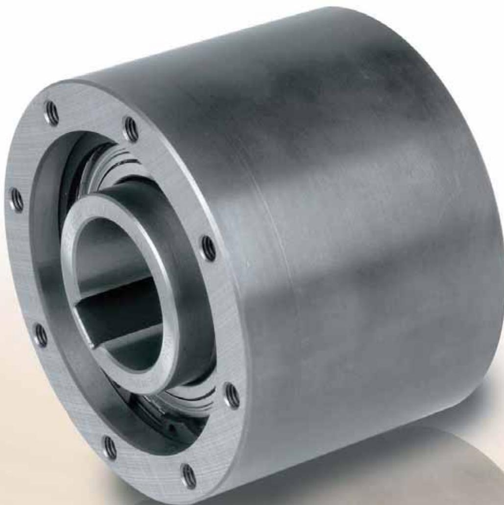
Le modèle SMZ est une roue libre à cames, étanche et autonome, centrée par deux roulements protégés de la série 60..ZZ.
