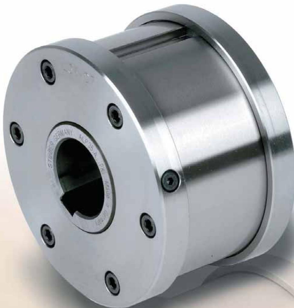
Le modèle ALP..F7D7 est une roue libre à rouleaux, étanche et autonome, aut centrée par deux roulements série 160.. qui n'est pas livrée lubrifiée.
