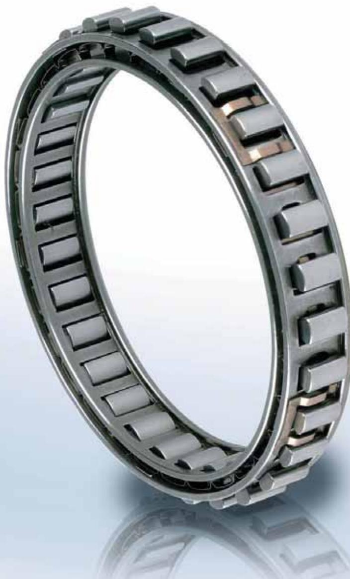
Le modèle DC est une cage roue libre à cames sans bagues ni intérieure ni extérieure. Il est nécessaire de l'intégrer dans un montage fournissant pistes ou bagues, roulements, lubrification et étanchéités. La version-N de ce modèle accepte tous les types de lubrifiants couramment utilisés dans les transmissions mécaniques.
