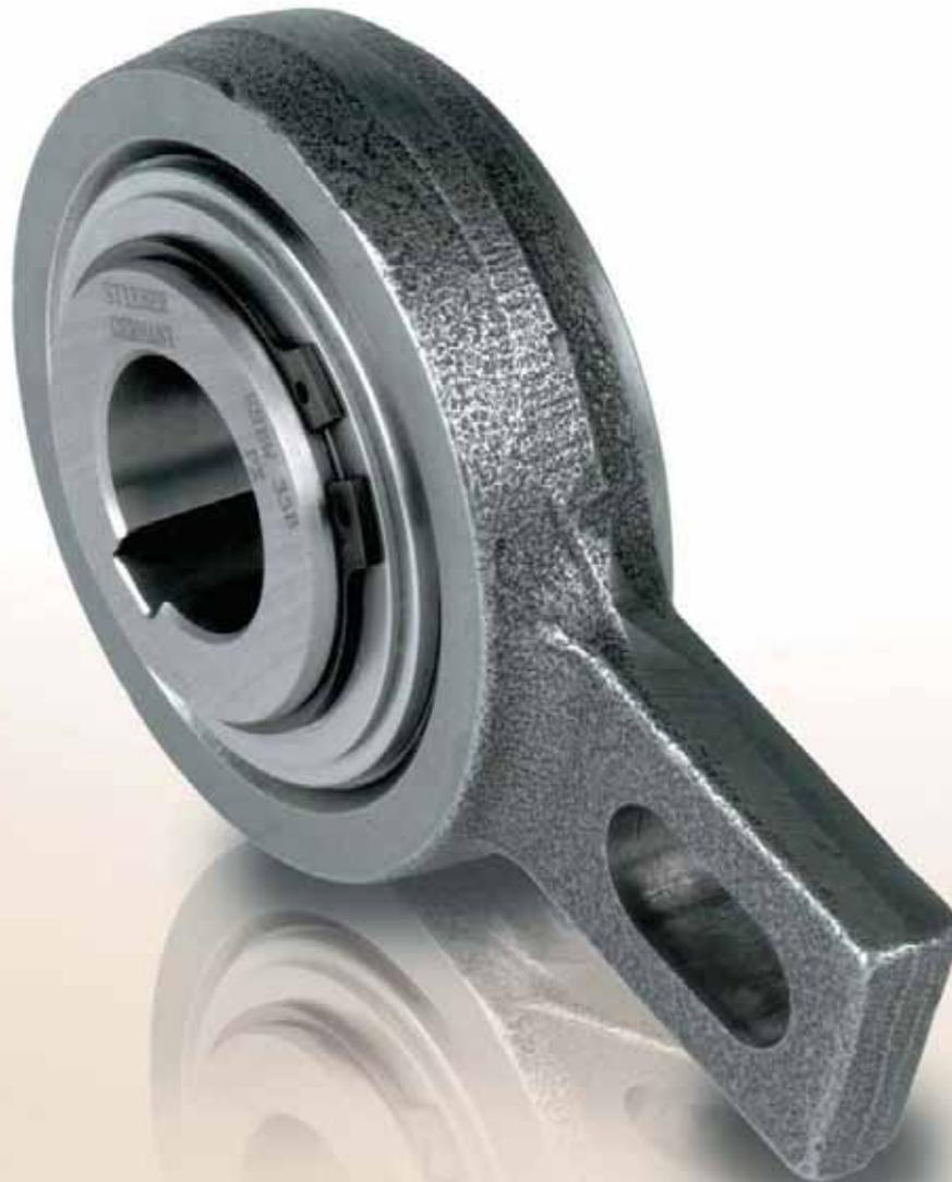
Le modèle RSBW est une roue libre à cames du type DC. C'est une version autonome, centrée par paliers lisses pour des vitesses de rotation faibles. Des joints toriques assurent l'étanchéité.
