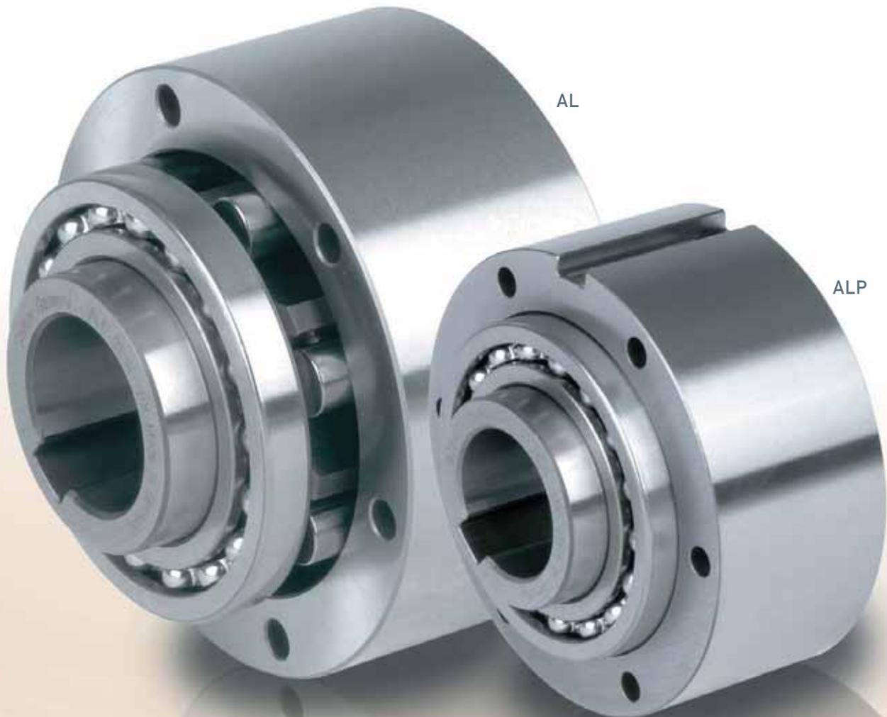
Les modèles AL, ALP sont des roues libres à rouleaux. Ce sont des modules de base autocentrés par deux roulements série 160.. En standard, une lubrification à l'huile est à prévoir.
