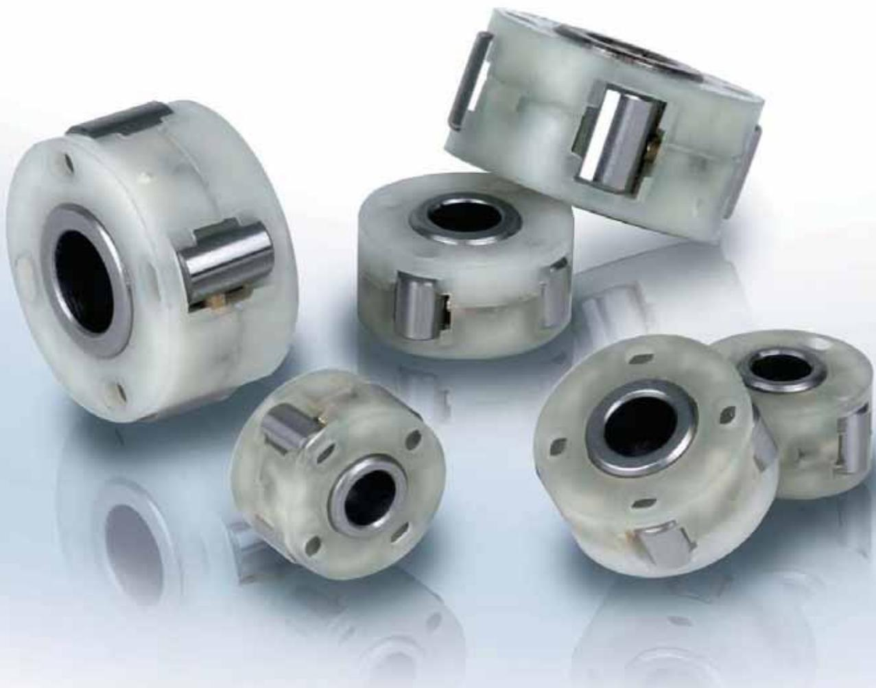
Le modèle KI est une roue libre à rouleaux. Il s'agit d'un ensemble non démontable composé de la bague intérieure et des rouleaux logés dans une cage en polyamide.
