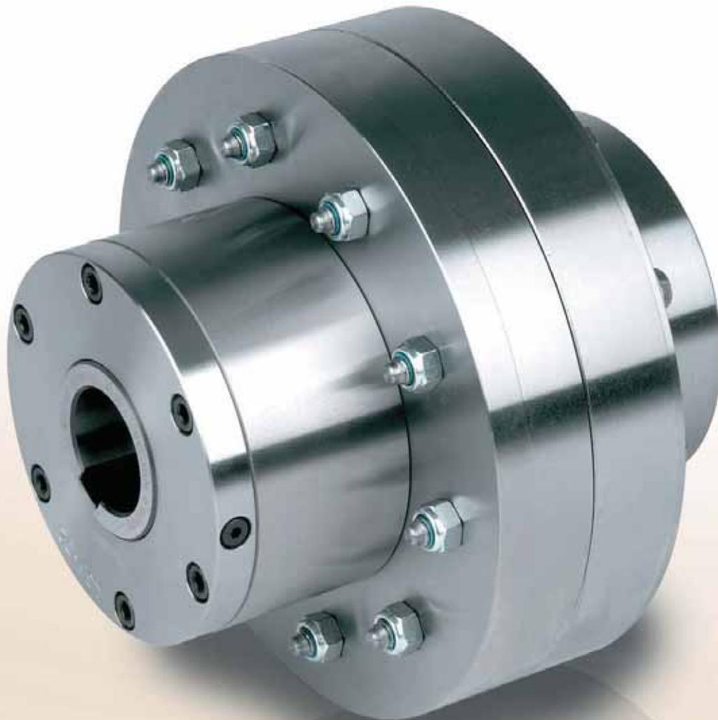
Le modèle AL..KEED2 est une roue libre à rouleaux, étanche et autonome, autocentrée par deux roulements série 160.. livrée lubrifiée à l'huile. Cette combinaison est utilisée comme embrayage à dépassement selon l'exemple de montage de la page ci-contre.
