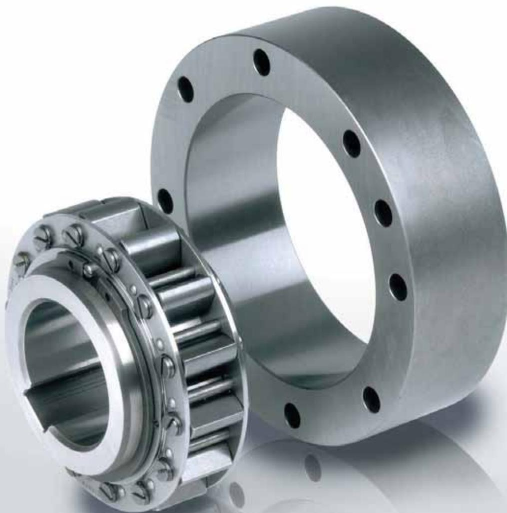
Le modèle RSCI est une roue libre à dégagement centrifuge des cames par rotation de la bague intérieure, qui seule est prévue pour tourner en roue libre.
