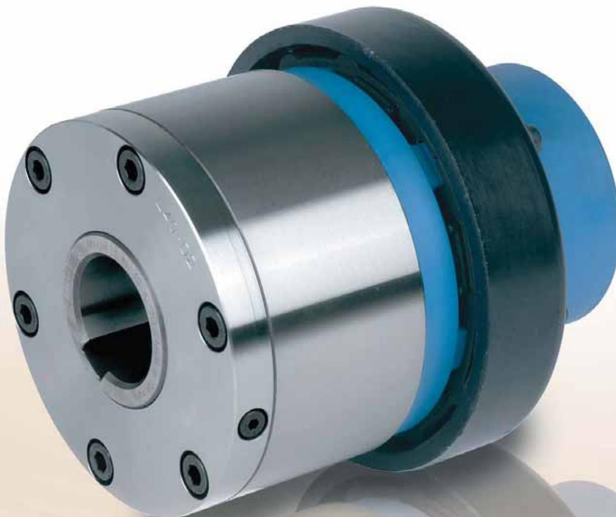
Le modèle AL..KMSD2 est une roue libre à rouleaux, étanche et autonome, aut centrée par deux roulements série 160.. livrée lubrifiée à l'huile. Cette combinaison est utilisée comme embrayage à dépassement selon l'exemple de montage de la page ci-contre.
