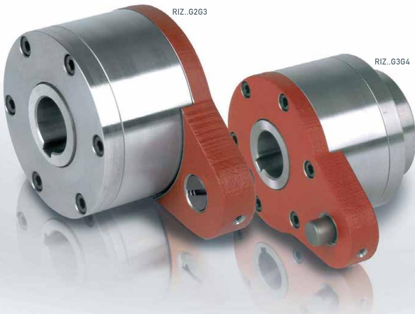
Les modèles RIZ..G2G3/G3G4 sont des roues libres à cames à dégagement centrifuge par rotation de la bague intérieure qui seule est prévue pour tourner en roue libre.
