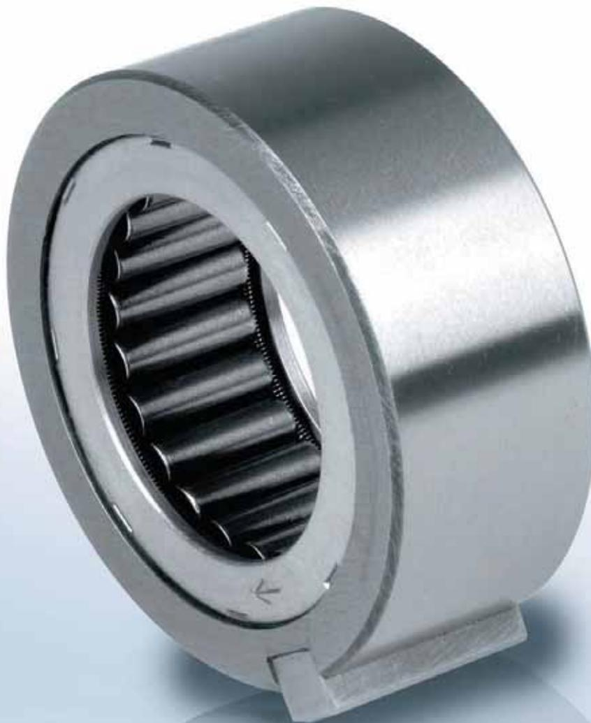
Le modèle S200 est une roue libre à cames, non autocentrée. Les cames fonctionnent directement sur l'arbre qui doit être prévu par l'utilisateur de même que la lubrification et l'étanchéité.
