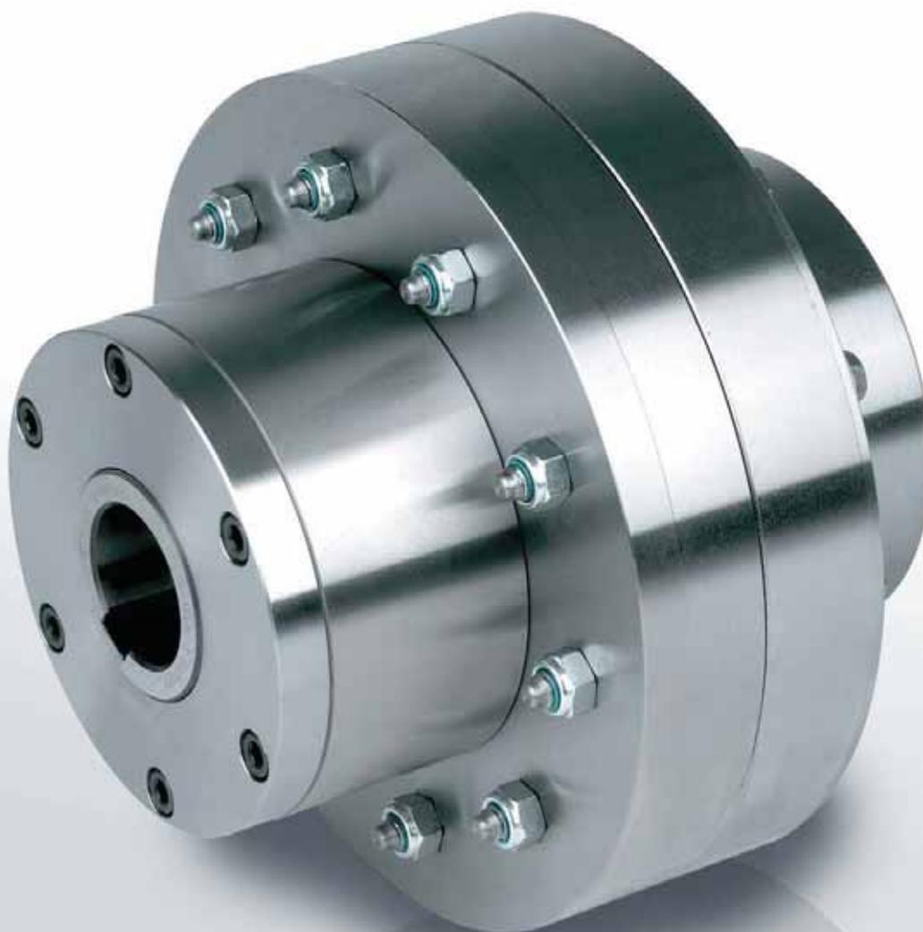
Le modèle RIZ..ELG2 est une roue libre à cames à dégagement centrifuge par rotation de la bague intérieure qui seule est prévue pour tourner en roue libre. C'est un ensemble autonome conçu pour des applications dites „de virage”. La vitesse de rotation en roue libre est élevée, mais basse en transmission de couple pour ne pas dépasser la vitesse maximum d'entraînement donnée dans le tableau des caractéristiques.
