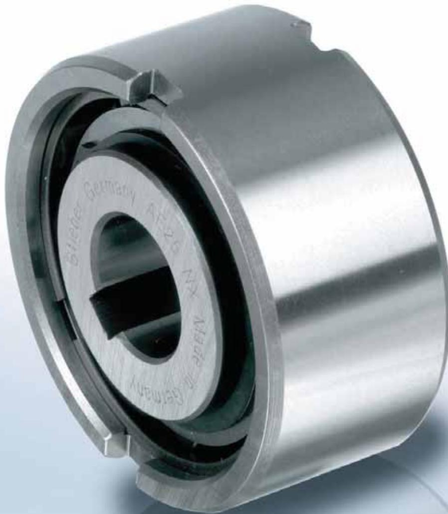
Le modèle AE est une roue libre à rouleaux non auto-centrée. Il est nécessaire de l'intégrer dans un montage fournissant roulements, lubrification et étanchéités.
