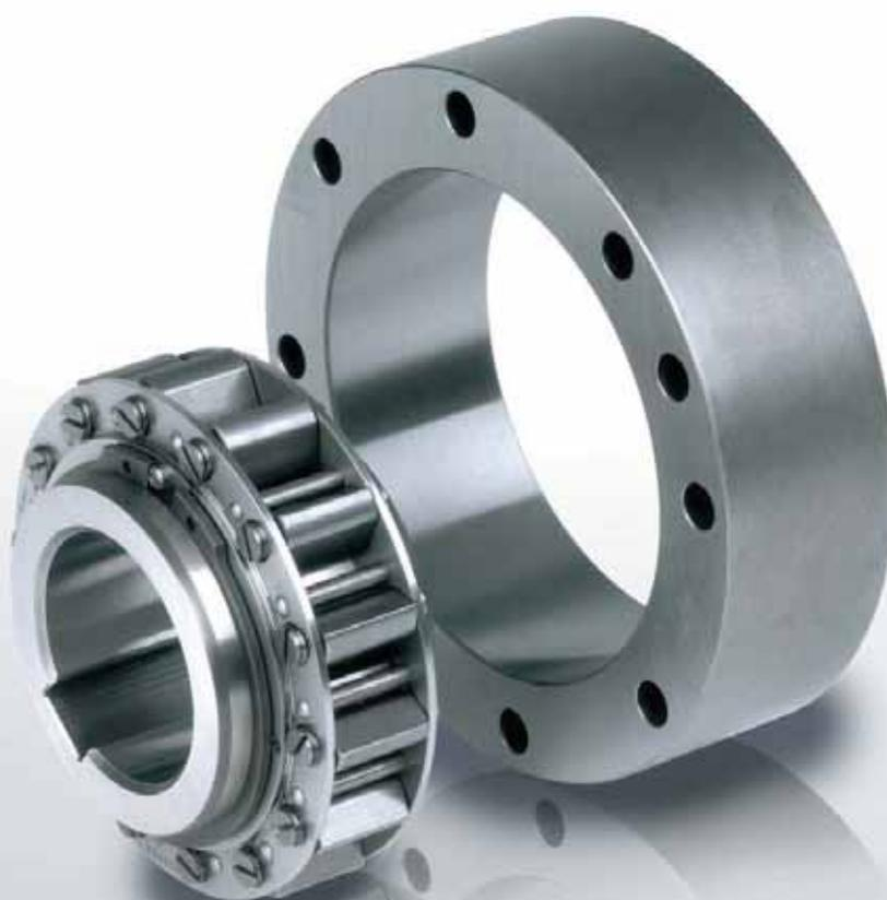
Le modèle RSCI est une roue libre à dégagement centrifuge des cames par rotation de la bague intérieure, qui seule est prévue pour tourner en roue libre. C'est une version non autocentrée.
