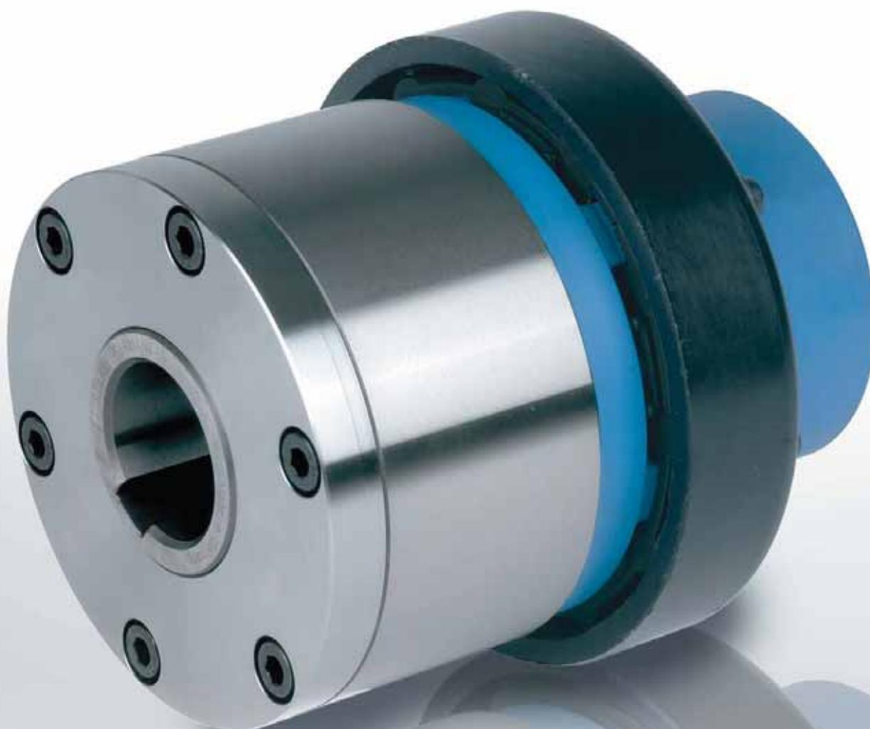
Le modèle RIZ..ESG2 est une roue libre à cames à dégagement centrifuge par rotation de la bague intérieure qui seule est prévue pour tourner en roue libre.
