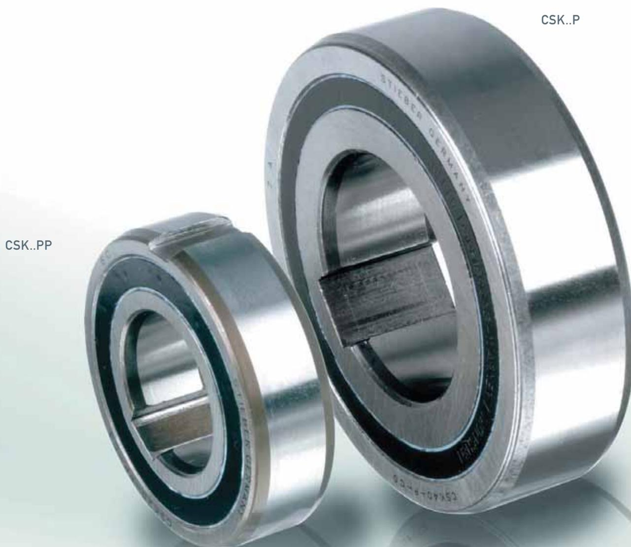
Les modèles CSK..P et CSK..PP sont des roues libres à cames, intégrées dans un roulement de la série 62.. (sauf taille 40). Ce sont des modèles autocentrés, livrés lubrifiés à la graisse et protégé contre les poussières de plus de 0,3 mm.
