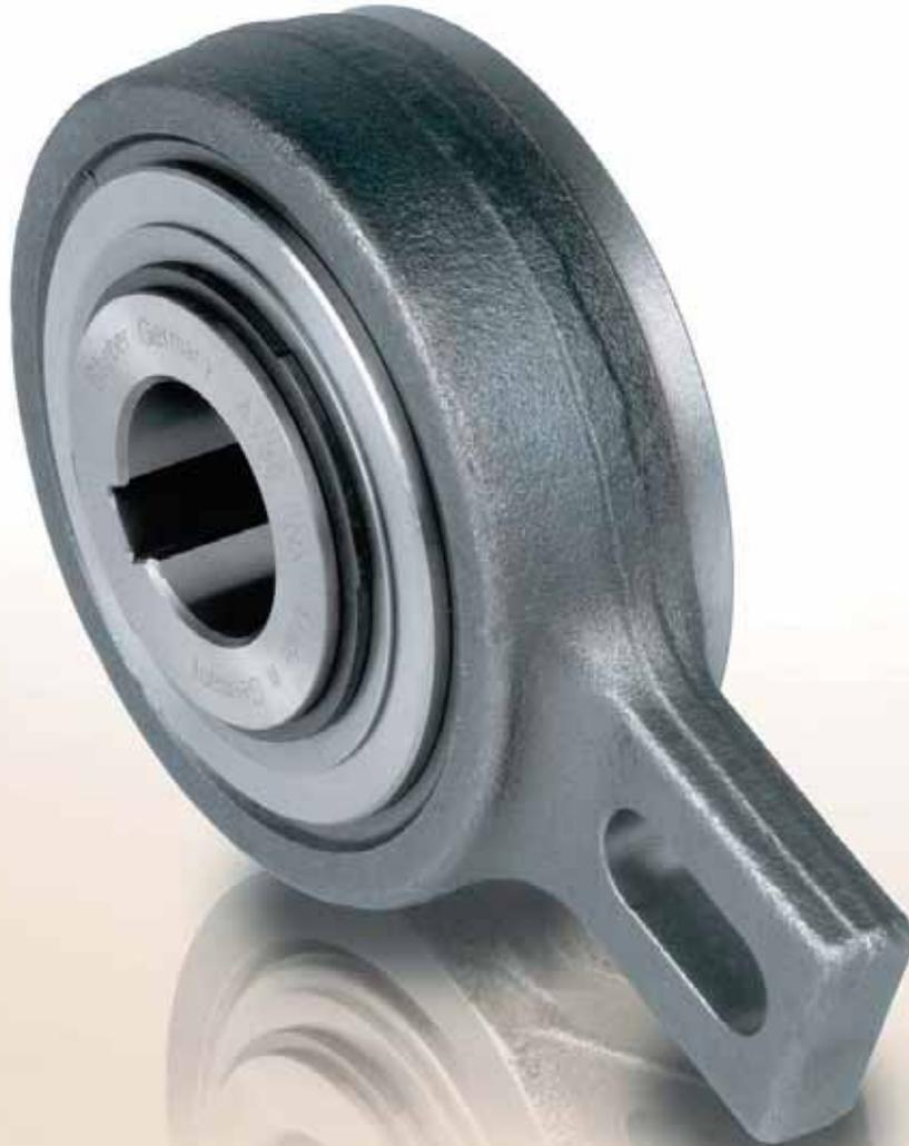
Le modèle AV est une roue libre à rouleaux. C'est une version autonome; centrée par paliers lisses pour des vitesses de rotation faibles. Des joints labyrinthe métalliques assurent l'étanchéité.
